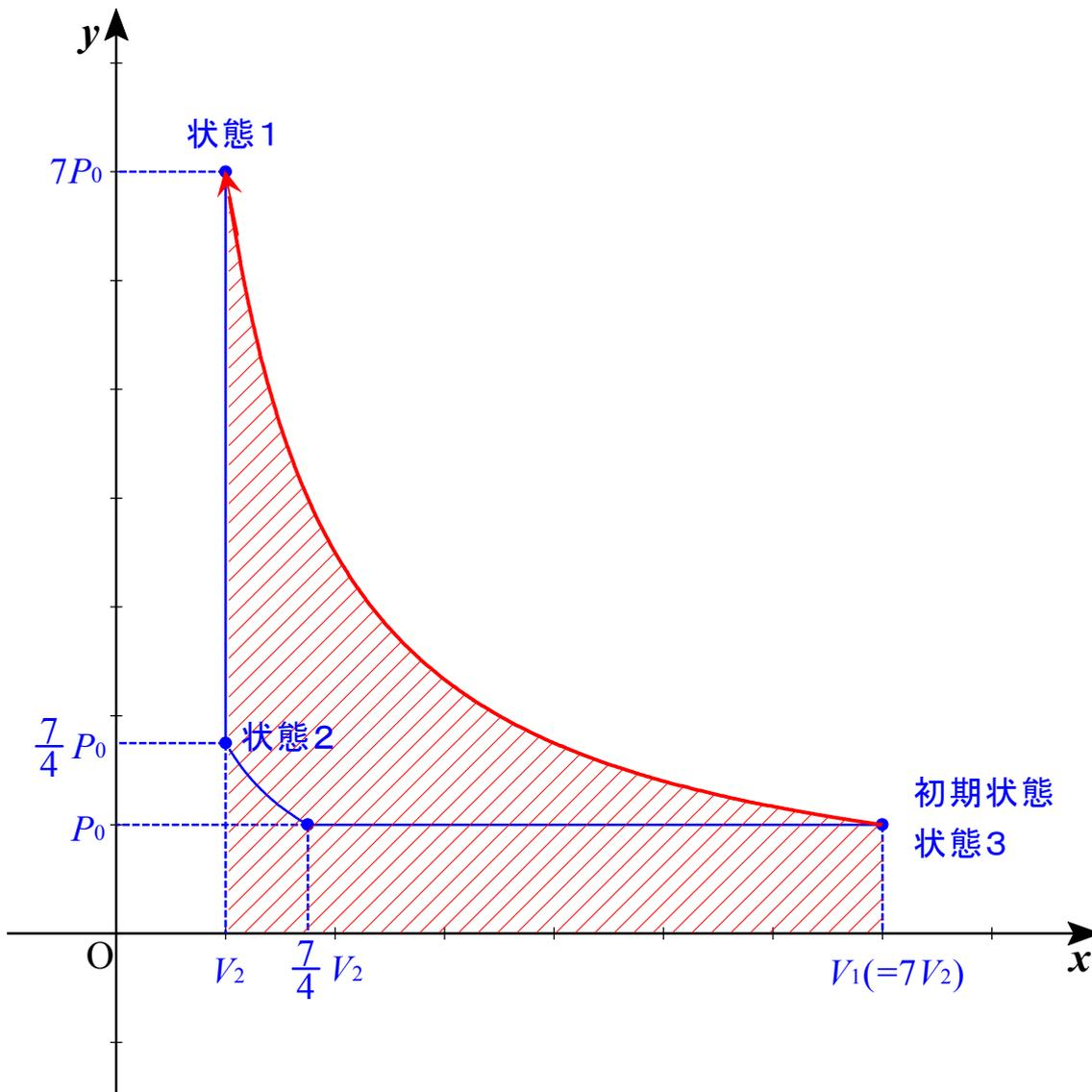
状態 2 から状態 3 に至る過程で右室の気体がピストンにした仕事
